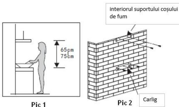
3. După stabilirea înălțimii de instalare a hotei, montați cârligul. Poziția fixă a suportului coșului interior stabilește poziția de instalare a coșului. Consultați "Picture 2".
