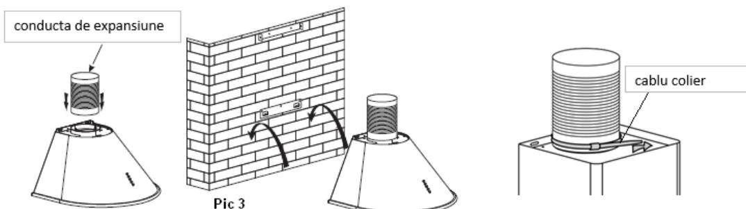
5. Fixați suportul coșului de fum exterior pe coșul de fum exterior și asigurați-vă că coșul interior poate fi reglat în mod liber. Apoi, instalați coșul pe hota și ridicați conducta de expansiune până când se scoate afara din perete prin orificiu. A se vedea imaginea 4.
