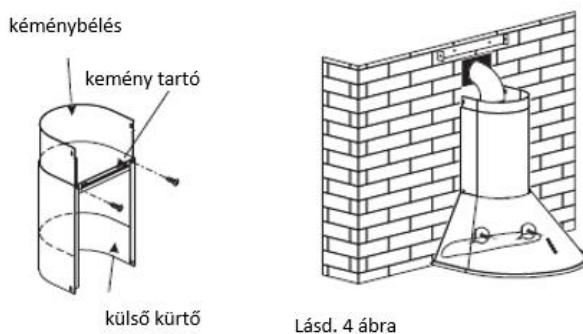
6. Állítsa be a belső kémény magasságát a belső kémény tartójának helyzetéhez, és rögzítse csavarokkal, közben rögzítse a külső kéményt a páraelszívó testére csavarokkal. A helyzet beállítása után rögzítse a testet biztonsági csavarokkal. Megjegyzés: A két biztonsági szellőzőnyílás a hátsó házon helyezkedik el, 6 mm átmérővel. Lásd az 5. képet
