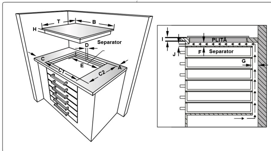
Aplicați banda de etanșare autocolantă cu o singură față pe întreg perimetrul marginii inferioare a plitei. Nu o întindeți.
