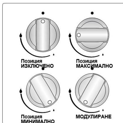
След запалването проверете визуално пламъците. Ако виждате жълт цвят на върха на пламъка, изключете газовия поток и проверете сглобката на чашките на горелката и короните след като се охладят. Уверете се, че няма течност в чашките на горелката. Ако пламъкът на горелката внезапно изгасне, изключете горелката, проветрете кухнята и изчакайте поне 90 секунди преди да направите опит за повторно запалване.
