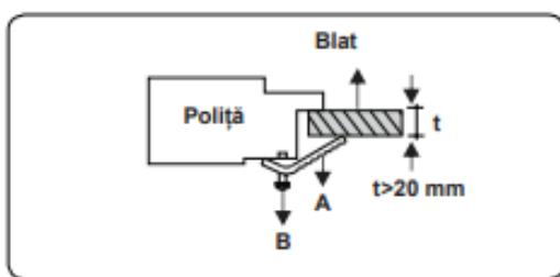
**Important:** Dacă aparatul urmează a fi instalat deasupra unui dulap sau a unui sertar este absolut esențial să amplasați un separator între baza aparatului și dulapul cu sertare.
