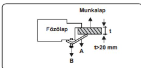
Ha a készüléket egy szekrény vagy fiók fölé szerelik, feltétlenül szükséges egy elválasztó szigetelést helyezni a készülék alja és a fiókos bútor közé.
