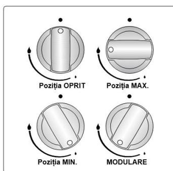
După aprindere, verificați vizual flăcările. Dacă vedeți o flăcără cu vârf galben, ridicată sau instabilă, opriți debitul de gaz, apoi verificați ansamblul capacelor și coroanelor arzătoarelor după ce s-au răcit. Asigurați-vă că nu există lichid în capacele arzătorului. Dacă flăcările arzătorului se opresc în mod accidental, opriți arzătoarele, aerisiți bucătăria cu aer proaspăt și nu încercați să reaprindeți timp de cel puțin 90 de secunde.
