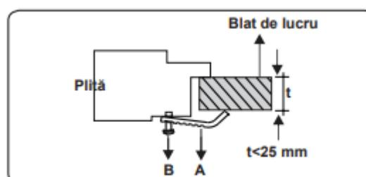
Important: Dacă aparatul urmează a fi instalat deasupra unui dulap sau a unui sertar este absolut esențial să amplasați un separator între baza aparatului și dulapul cu sertare.
